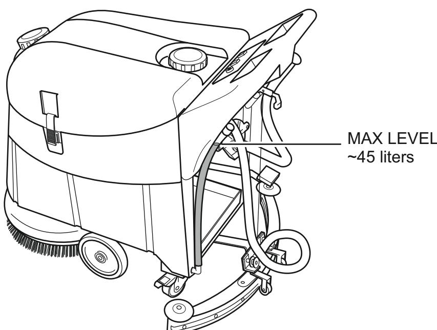
**Serbatoio di recupero:** Il serbatoio di recupero viene vuotato (preferibilmente ad ogni fine lavoro) in modo da non lasciare decantare lo sporco; a tale scopo togliere il tappo del tubo di scarico **M2**, che è semplicemente mantenuto in posizione di lavoro da una molletta di fermo, ed immetterlo in un pozzetto perdente che rispetti i canoni di protezione ambientali dettati dalla legge nel paese di utilizzo. Oppure svuotare il serbatoio e pulirlo con l'aiuto del tappo **M0**.
